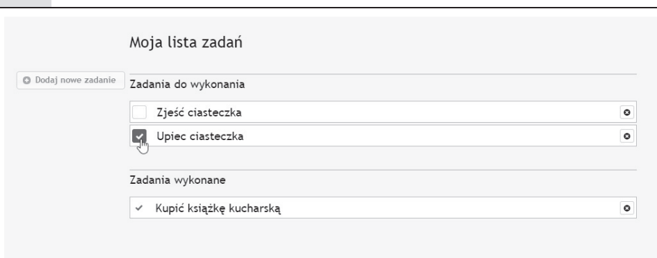
Rysunek 14.4. Pole wyboru oraz przycisk, który pozwala oznaczyć zadanie jako wykonane oraz je usunąć, zmieniają wygląd po wskazaniu ich myszą. Możliwość tej nie zapewnia jednak kod JavaScript, lecz style CSS. A konkretnie, pseudoklasa :hover pozwalająca na zmianę wyglądu elementu, na którym znajduje się wskaźnik myszy. Aby sprawdzić, jak tworzony jest ten efekt, zajrzyj do pliku todo.css umieszczonego w podkatalogu css katalogu R14
